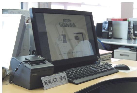
タッチパネル式の予約端末 左端の IC カードリーダーで簡単にログイン可能
