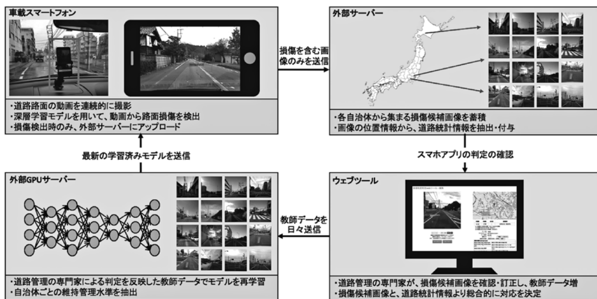
図1 本研究のスマートフォンを用いた画像の収集からモデル更新のフレームワーク
