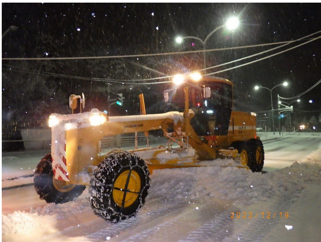
図表 付ー３ グレーダでの除雪作業
