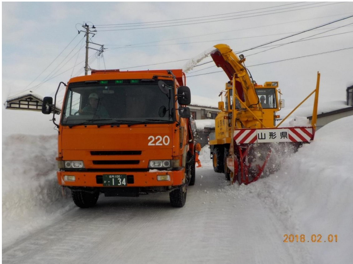
図表 付－8 運搬排雪作業
