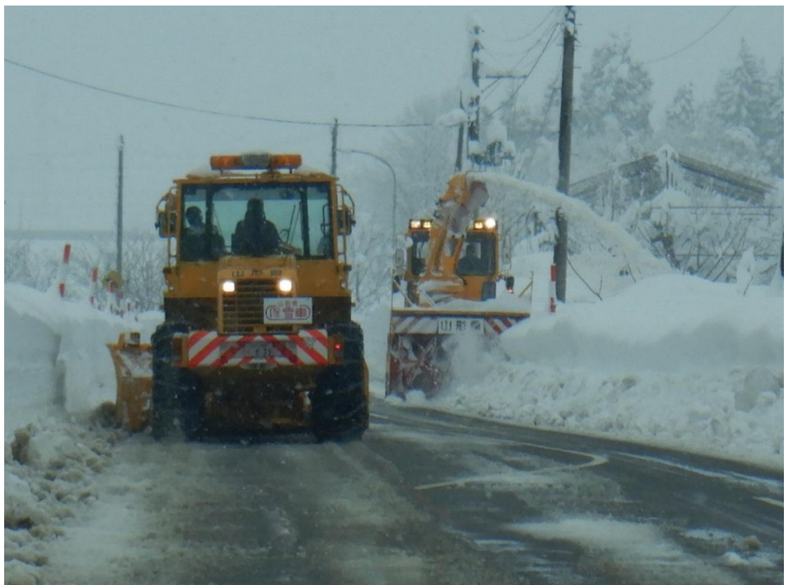
図表 付ー５ ドーザとロータリでの除雪作業
